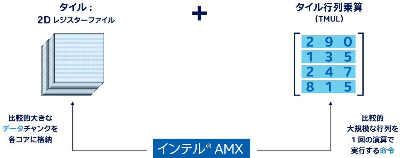
図5. 2Dレジスタファイル (タイル) とTMULで構成されるインテル® AMXアーキテクチャー
