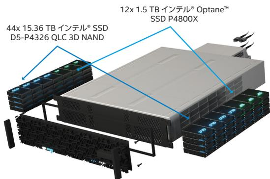
インテル® Optane™ メディアの低レイテンシーと高耐久性は、VAST Data のノード上の CPU と密接に連携してデータブロックを処理するのに最適な技術です。このコンポーネントが連携することで、非常に広いデータ・ストライプを形成し、QLC ドライブに効率的に書き込むことができます。このプロセスにより、QLCメディアの耐用年数が延び、データ保護のために非常に効率的な消去符号化が行われ、データ削減アルゴリズムが実装されます。
