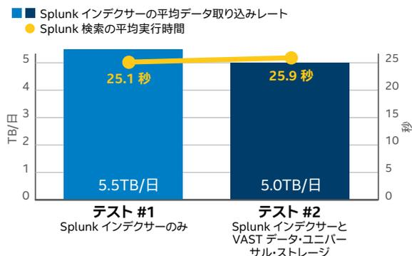
図 4. コールドデータを VAST Data ユニバーサル・ストレージに配置した場合、Splunk インデクサーのデータ取り込み速度はわずかに低下、Splunk 検索の平均実行時間はわずかな増加にとどまります。
