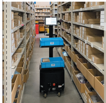
図 1. 日本通運の平和島ロジスティクスセンターで稼働するラピュタロボティクスの協働型ピッキング・アシスト・ロボット「ラピュタ PA-AMR」 (提供:ラピュタロボティクス)
