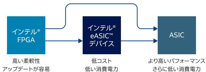
図 1. インテルが提供する、FPGA からインテル® eASIC™ デバイスや ASIC への移行パス。コスト削減、消費電力の低減、パフォーマンス向上を実現
