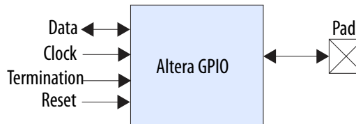
図 -7: アルテラ GPIO のインターフェイス信号
