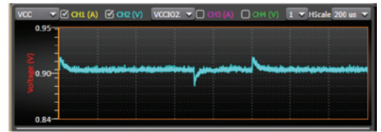
インテル® FPGA V CC 過渡負荷応答 特性: 2%以下のV OUT 変動
