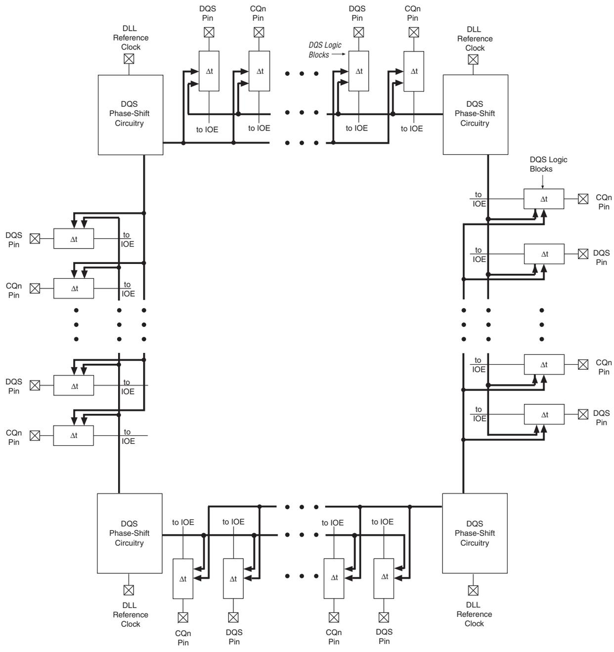
The DQS phase-shift circuitry is connected to the DQS logic blocks that control each DQS or CQn pin. The DQS logic blocks allow the DQS delay settings to be updated concurrently at every DQS or CQn pin.
