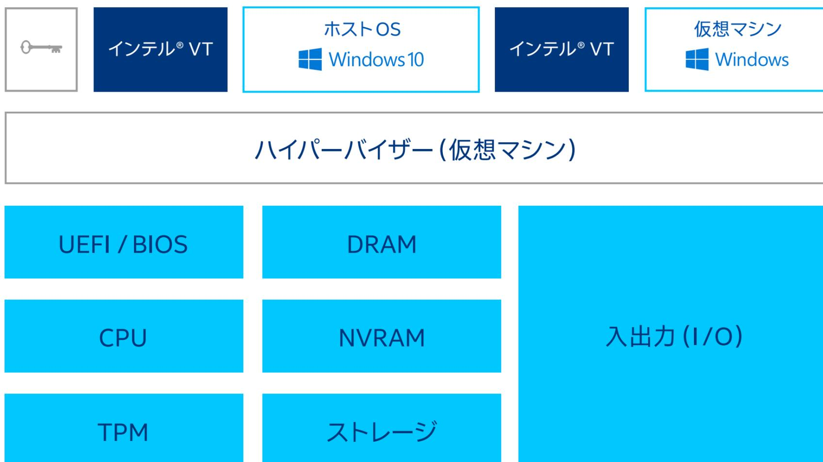
図3. インテル® vPro® プラットフォーム上のインテル® VTがワークロードの分離を可能にし、分離された仮想マシン (VM) の作成をサポートすることにより、攻撃対象領域だけでなく、マルウェアがリソース全体に固着・拡散する可能性も縮小
